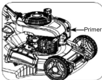
2. Stare dietro il tosaerba. Tirare la leva di avvio/arresto del motore verso la maniglia superiore. Con una mano posizionando l'altra mano sulla maniglia di avviamento.
